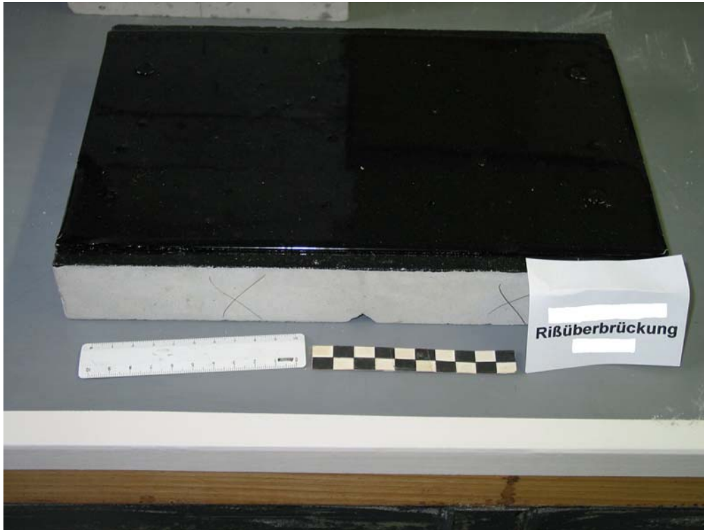
Bild 9 : Rißüberbrückung „Oxidbitumen“ im Originalzustand
