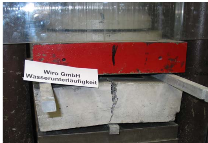
Bild 3 : Brechen der Betonplatte
