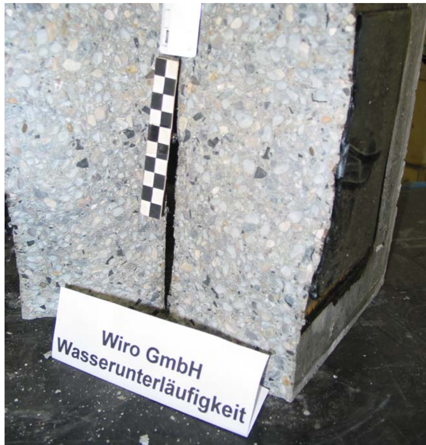
Bild 5 : gebrochene Betonplatte (Bruchfläche)
