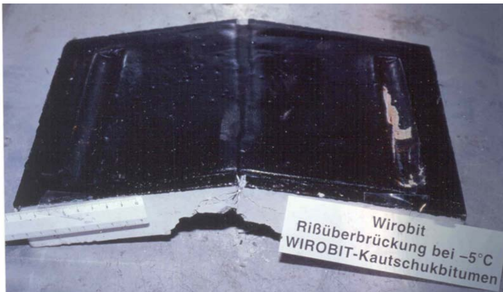
Bild 8 : Ausbau nach ca. 10 mm Rißüberbrückung mit „WIROBIT-Kautschukbitumen“
